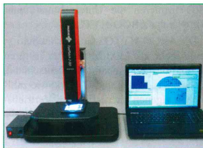
Abb.: Bildanalyzesystem Pamas FastPatch 2GO für die Partikelanalyse von dunklen und stark verschmutzten Flüssigkeiten
